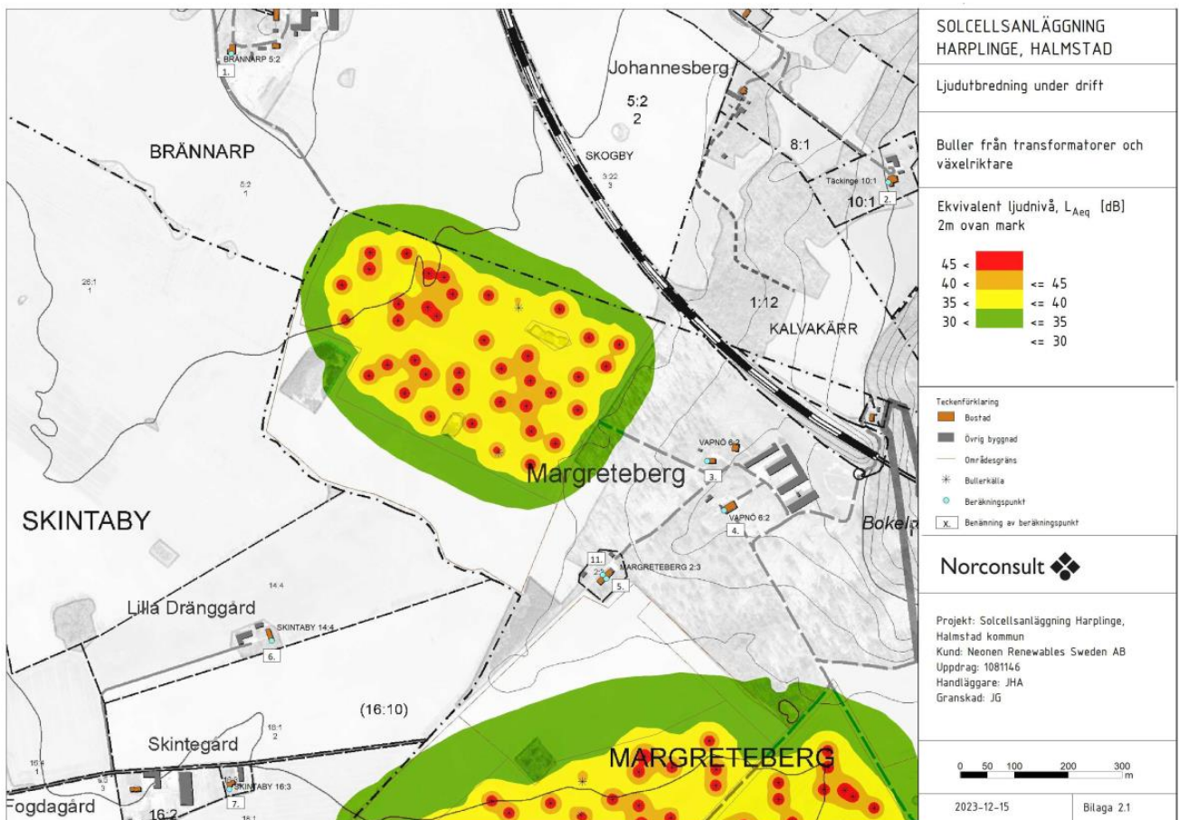
Figur 13. Översiktsskarta ekvivalent ljudnivå under drift (buller från transformatorer och växelriktare i solcellsanläggningens norra delar
